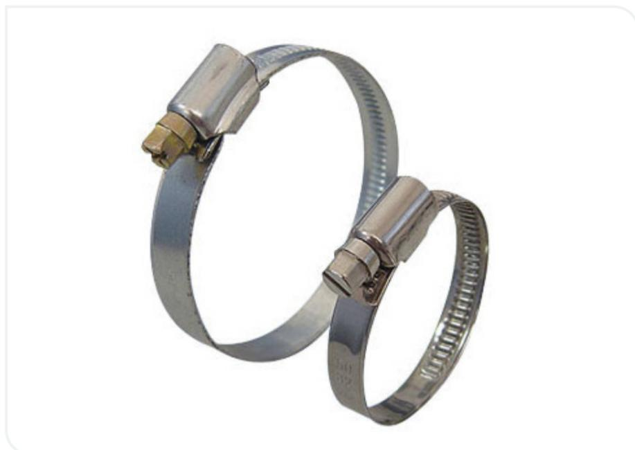
**Особенность конструкции** - прочный замок червячного соединения с цельно-штампованным корпусом, в котором обеспечен стабильный зазор и оптимальный угол резьбы в паре винт-лента, что в сочетании с высокоточным исполнением и использованием специальной алюминизированной стали, обеспечивает равномерное усилие сжатия по периметру, большой предельный момент при затяжке, высокую вибростойкость и наработку на отказ.
