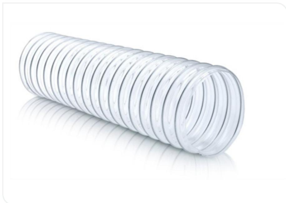
Абразивостойкий напорно-всасывающий рукав из полиуретана, гибкий. Рукав имеет малый радиус изгиба, повышенные требования к износостойкости, высокую прочность на разрыв и растяжение, хорошую прочность на прокол, устойчив к маслам, нефтепродуктам и бензину, к атмосферному воздействию, газогерметичный, при заземлении стальной спирали не накапливает статическое электричество.
