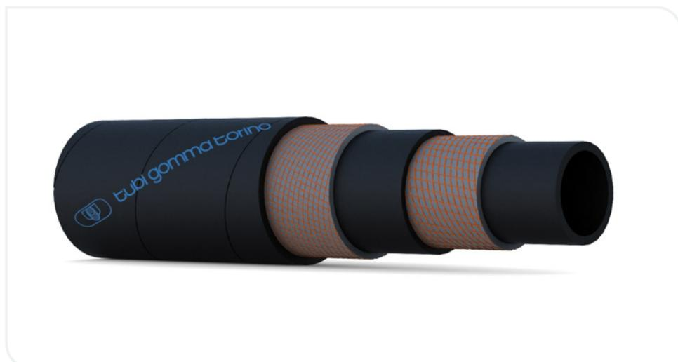
**Применение:** рукав для подачи сжатого воздуха высоких температур. Подходит для использования в пневмоинструментах в угледобывающей промышленности, при прокладке дорог и тоннелей и пр.
